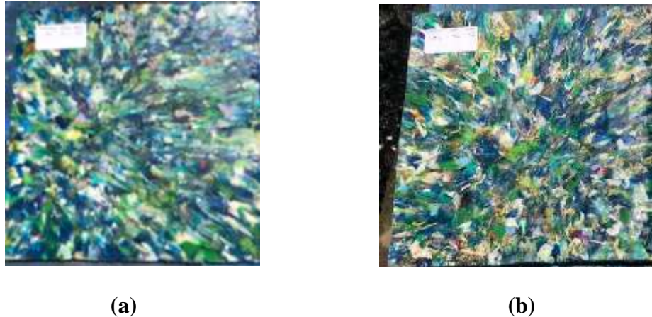
Gambar 2. (a) Papan polimer dengan variasi C penambahan 10% MAH, (b) Papan polimer dengan variasi D penambahan 10% MAH.
