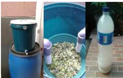
Gambar 2. Rangkaian Alat Fermentasi Sampah Organik Rumah Tangga
