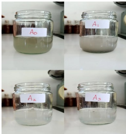
Gambar 2. Hasil filtrasi limbah cair tahu dengan arang aktif teratai
