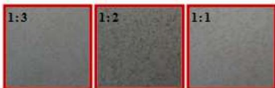
Gambar 6. Kertas dengan komposisi loading ampas tebu dan sekam padi pada t = 60 menit dan NaOH 5% (w/v) pada perbandingan (a)1:3; (b)1:2 dan (c)1:1
