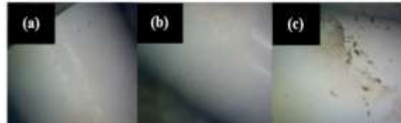
Gambar 2. (a) Membran Kalsinasi Suhu 200 °C (b) Membran Kalsinasi Suhu 250 °C dan (c) Membran Kalsinasi Suhu 600 °C
