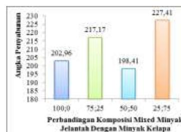
**Gambar 5.** Hubungan Antara Angka Penyabunan dengan Variasi Komposisi *Mixed* Minyak
