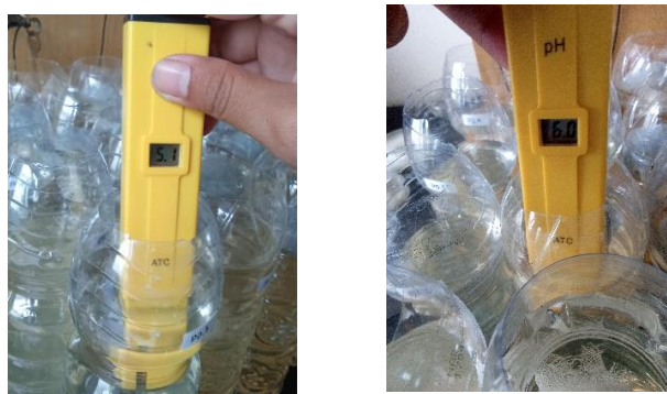
Gambar 3. pH sampel Air sungai sebelum (a) dan sesudah (b) pengukuran
