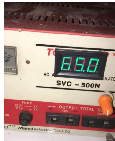
Gambar 3. Power Supply elektroforesis (60-150 volt, 2-3 A) hasil rancang bangun. Power supply menunjukkan 140 volt DC (3A) dan 65 volt DC (3B).
