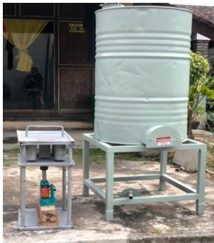
Gambar 1 Persiapan Alat Pembakar Sekam (Kanan) dan Alat Pengepres/Pencetak Briket (Kiri)
