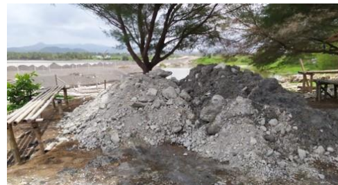
Gambar 1 Deposit Material Limbah Sisa pada Batching Plant
