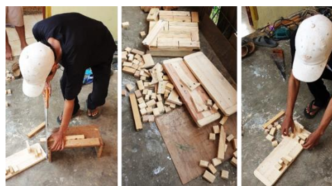
Gambar 3 Proses Pemotongan Kayu Menjadi Balok-Balok Kecil (Kiri), Hasil Pemotongan Kayu (Tengah), dan Proses Pembuatan Mosaik (Kanan)
