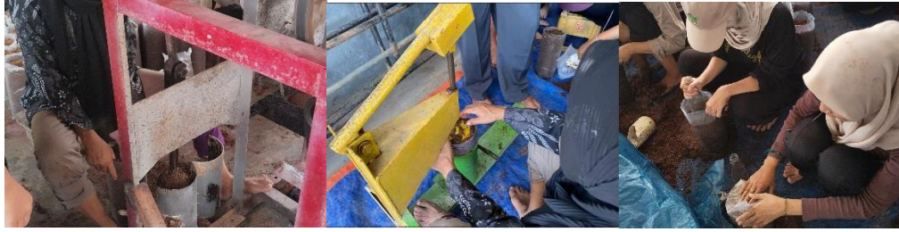
Gambar 5. Mempres boglog: (a) Menggunakan alat press mesin, (b) Menggunakan alat press manual dengan ditekan, (c) Menggunakan botol sebagai alat press
