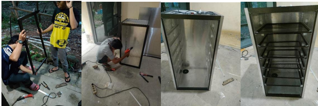
(a) (b) (c) (d) Gambar 2.2. (a). Perakitan kerangka alat pengering, (b). Pembuatan body alat pengering, (c) Lanjutan pembuatan alat pengering (tanpa rak) dan (d). Lanjutan pembuatan alat pengering (dengan rak)
