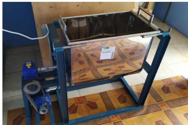
Gambar 2. Alat pencampur (*mixer*)
