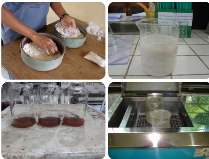
Gambar 2. Simulasi pembuatan gula cair dari pati sagu skala laboratorium.
