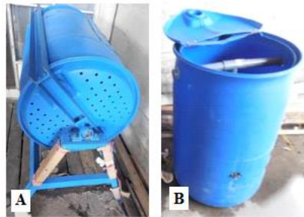
Gambar 1. Komposter untuk membuat bokashi dan pakan ternak yang siap digunakan oleh masyarakat (A = model rolling , B = model biasa).
