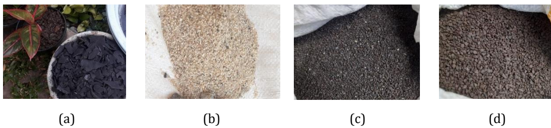
Gambar 2. Bahan media filter air yang digunakan (a) arang batok kelapa, (b) pasir silika, (c) ferolite, dan (d) mangan
