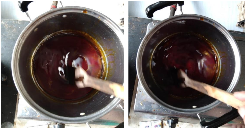
Gambar 3. Pencairan kembali bahan sabun untuk memperoleh sabun cair
