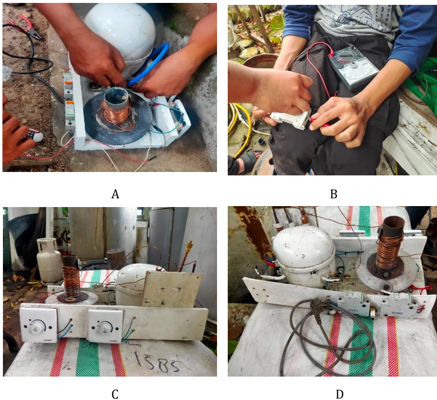
Gambar 6. Perakitan alat GC sederhana sebelum dipraktikkan kepada mahasiswa kimia semester 5 (A dan B). Tampilan alat tampak depan (C) terdapat dua buah dimmer untuk pengatur panas dan laju alir kompressor. Tampilan alat tampak belakang (D) terdapat dua buah saklar dan kabel untuk menyambungkan ke arus listrik
