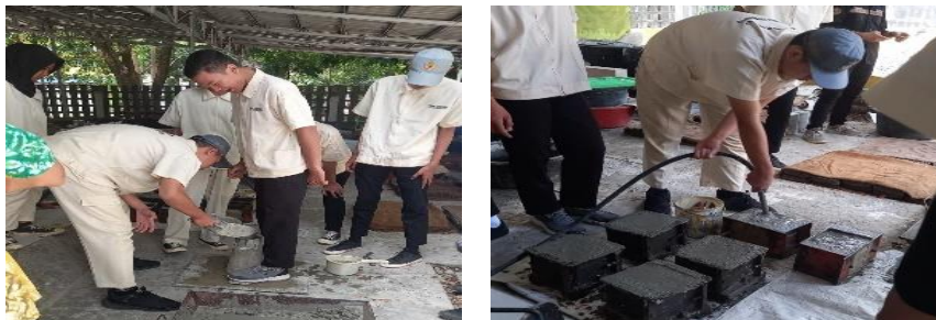
Gambar 4. Pengujian slump dan pembuatan beton
