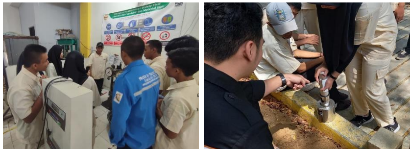
Gambar 4. Pengujian kuat tekan beton yang merusak dan tidak merusak
