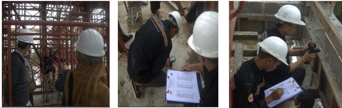
Gambar 5. Pengujian Ultrasonic Pulse Velocity pada Bangunan Kantor di Banjarbaru
