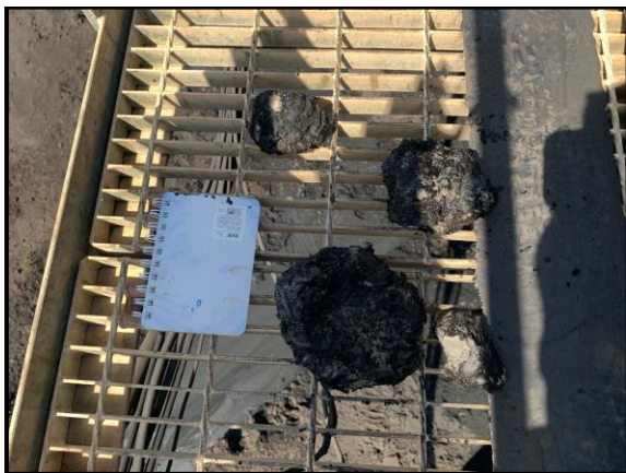
Gambar-20. Material pengotor pada area Crushing Plant
