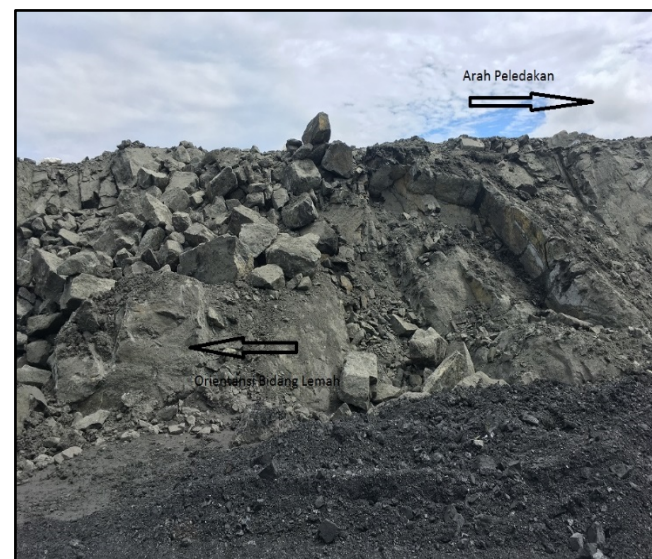
Gambar-2. Arah peledakan dan orientasi bidang lemah
