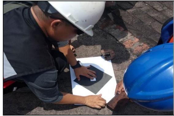
**Gambar-9.** Penempatan Titik Ground Control Point (GCP)
