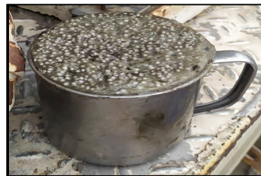
Gambar-2. Explosive tidak dilakukan pengecekan density
