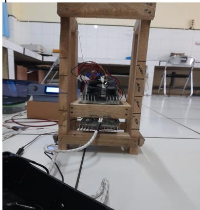
Gambar 9. Pengambilan data pada posisi elemen setrika berada di bawah termoelektrik
