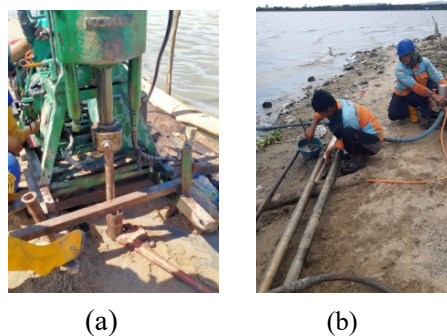
Gambar 5 (a) Proses Pengeboran, (b) Proses Mengeluarkan sampel dari Core Barrel dengan Mesin Kompresor
