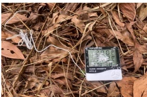
Gambar 1. Pengukuran Suhu dan Kelembaban menggunakan Termohygrometer
