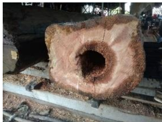
Gambar 6. Bentuk kayu meranti yang tidak beraturan dan berlobang yang tidak diambil sampel
