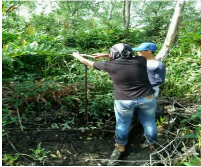
Gambar 1. Bor Eijkelkamp untuk menduga kedalaman gambut dan mengambil sampel Tanah
