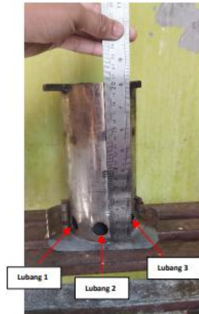
Gambar 1. Tungku Modifikasi 3 Lubang
