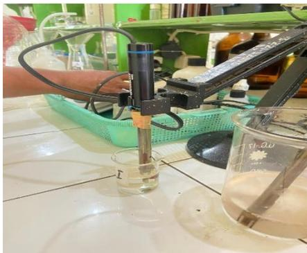
Gambar 2. Alat untuk mengukur pH
