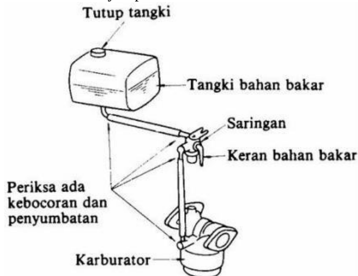
Gambar 2. Skema Sistem Bahan Bakar Konvensional
