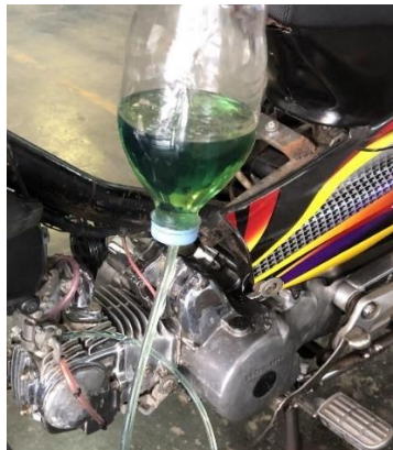
Gambar 8. Instalasi Alat Uji Tanpa Aerator
