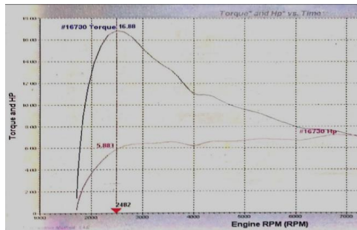
Gambar 8. Hasil Dynotest Menggunakan Intake Manifold 7 cm (Original Pabrik)
