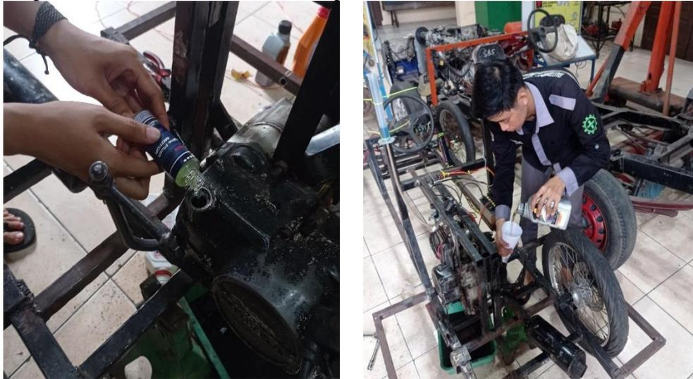
Gambar 4. Memasukkan Cairan Engine Flush Dan Memasukkan Oli Mesin Ke Penampung Oli
