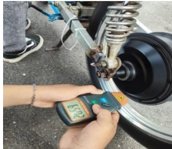
Gambar 15. Kabel Pengukuran Menggunakan Tachometer
