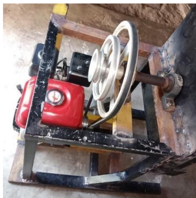
Gambar 10. Pemasangan Sabuk V-Belt
