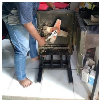
Gambar 9. Pemasangan Mata Pisau
