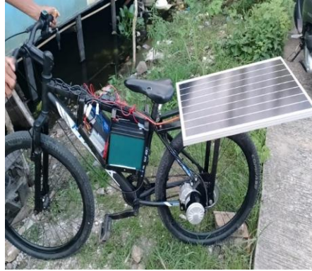
Gambar 16. Pengisian Energi Baterai Solar Cell Dengan Energi Matahari
