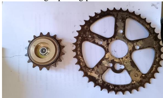
Gambar 14. Perbandingan Gear Teeth Sepeda
