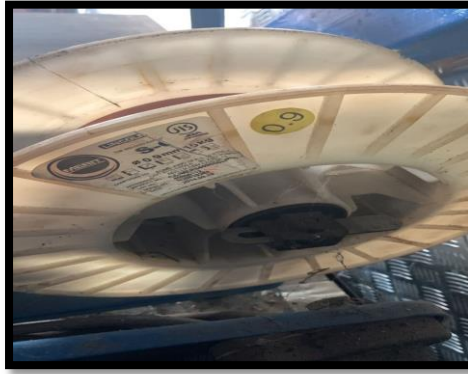
Gambar 10. Elektroda AWS SFA – 5.18 ER70S – 6
