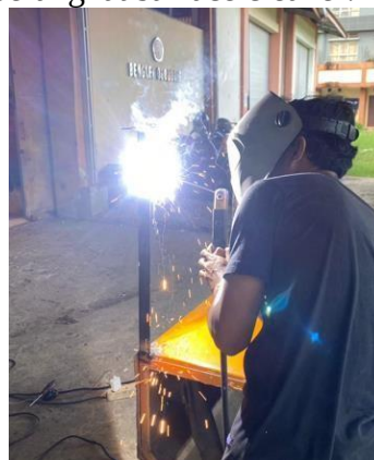
Gambar 7. Proses Pengelasan Pada Rangka
