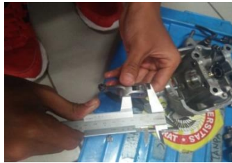
Gambar 5. Pengukuran Rocker Arm Menggunakan Jangka Sorong
