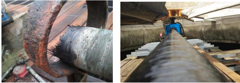
Gambar 14. Spacer Coupling sebelum (kiri) dan sesudah (kanan) perbaikan
