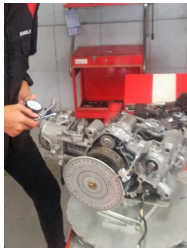
Gambar 14. Pengukuran Durasi Camshaft
