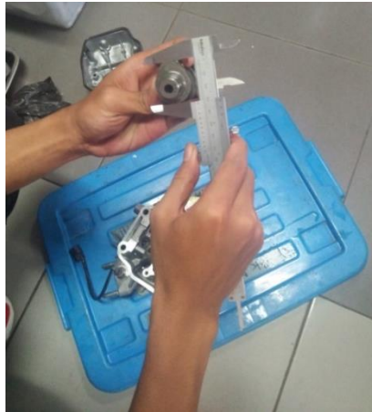
Gambar 13. Pengukuran Dimensi Camshaft
