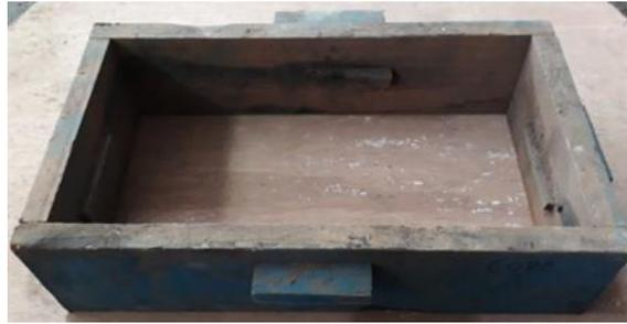
Gambar 5. Rangka Cetak Dari Kayu
