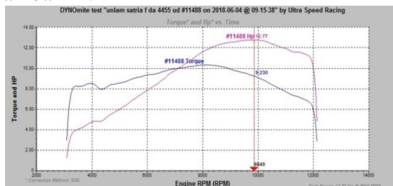
Gambar 22. Grafik Hasil Pengujian Daya Dan Torsi Knalpot Dengan Filter Gas Buang Gypsum Ketebalan 1 cm
