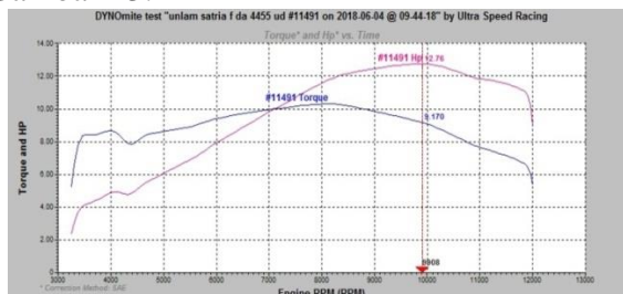
Gambar 24. Grafik Hasil Pengujian Daya Dan Torsi Knalpot Dengan Filter Gas Buang Gypsum Ketebalan 3 cm
