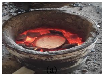
Gambar 10. (a) Peleburan Material Wajan (b) Penuangan Material Yang Sudah Mencair Ke Cetakan
