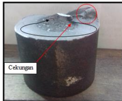
Gambar 11. Tampak Samping Dari Poros Roda Belakang
