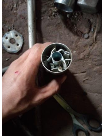
Gambar 2. Katalis Dengan Penggunaan Filter Aluminium
