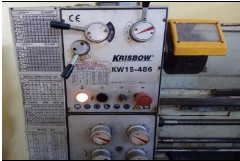
Gambar 2. Mesin Bubut Krisbow KW15-486
