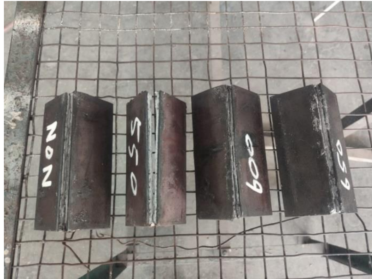
Gambar 12. Spesimen Hasil Uji Kekuatan Tekan
