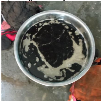
Gambar 4. Proses Pendinginan Spesimen
